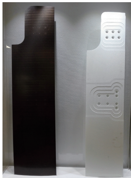
前起落架舱门试验件与ROHACELL® HERO芯材
